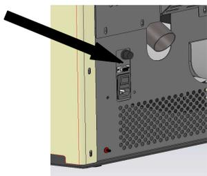
En el conducto de pellets hay una sonda de temperatura conectada a un termostato de seguridad que, en caso de calentamiento excesivo ( $> 85\text{ }^{\circ}\text{C}$ ), desactiva automáticamente la alimentación del pellet. En este caso, el extractor de humos o los ventiladores siguen funcionando para enfriar rápidamente la estufa. La anomalía se indica en el panel de mandos con el mensaje "AL 7 SEGUR TERMICA". Si actúa el termostato:
