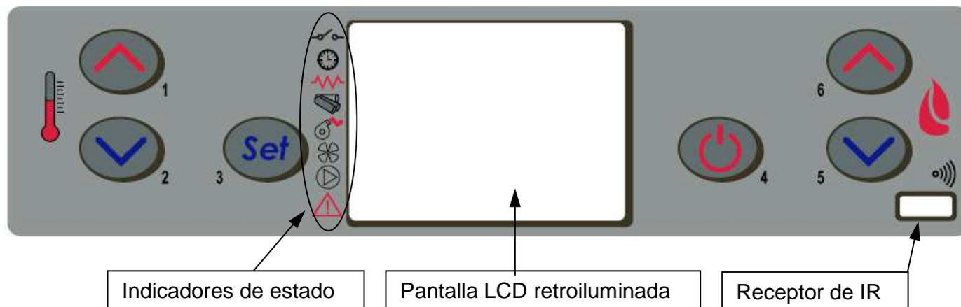
El panel permite encender y apagar la estufa, regularla durante el funcionamiento y ajustar los programas de gestión y mantenimiento.
