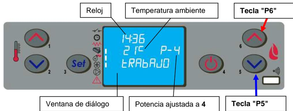
Además de la potencia, también se puede regular la temperatura ambiente, directamente en el panel de mandos con las teclas "P1" y "P2": en pantalla aparece la consigna (SET) actual de temperatura. Para la ventilación del aire caliente, la estufa regula automáticamente la velocidad en función de la potencia programada.
