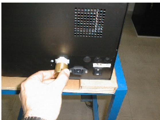
Instale, si no está instalado, un grifo de 3/4" gas para separar el aparato de la red en caso de necesidad.
