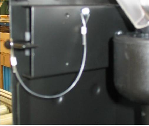
En el distribuidor existe un interruptor de seguridad que corta la tensión de todos los componentes eléctricos y electrónicos del distribuidor cuando se abre la puerta.
