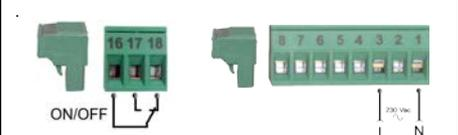
⑥ ON/OFF. Salida de estado de posición del interruptor magnetotérmica.
