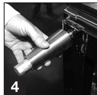
4 Atornille la pata en la parte inferior de la base del gabinete.
