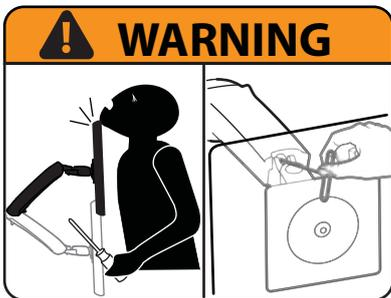
**ADVERTENCIA:** Riesgo de energía almacenada: El mecanismo del brazo está bajo tensión y se moverá rápidamente hacia arriba, por sí mismo, tan pronto como se retire el equipo acoplado. Por ello, NO retire el equipo a menos que esté colocado en su posición más elevada. El incumplimiento de esta instrucción puede provocar lesiones personales graves y dañar el equipo.
