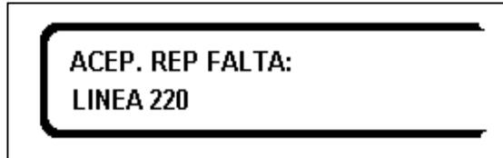
El sistema debe ser reseteado. Para resetear la central debe mantenerse apretada la tecla ACEPTAR ALARMA.
