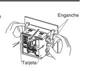
Si tira hacia delante del adaptador de montaje en panel con uno de los enganches sin quitar, tanto el adaptador como el producto pueden sufrir daños.
