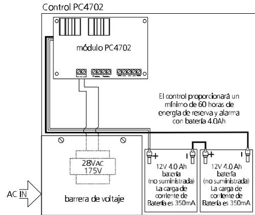
INSTALE EL CABLEADO DE BATERÍA Y CA COMO SE MUESTRA AQUÍ
