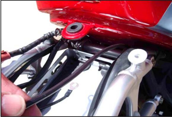
Guía ambos extremos de los cables con terminales de anilla hacia la batería.
