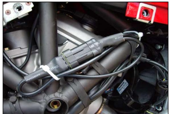
Coloque bridas en cualquier cable suelto.
