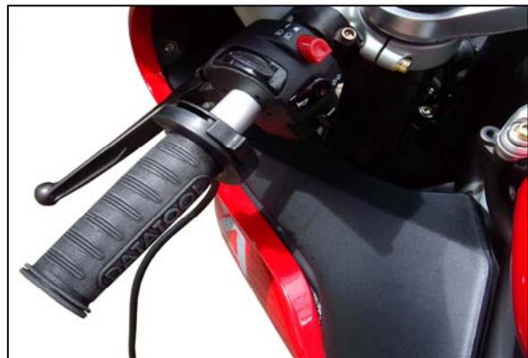
Cubra el extremo izquierdo de la barra y el interior de los puños calefactores con un pegamento de impacto adecuado. A continuación, introduzca los heated grips en su totalidad en la barra, asegurando que los cables salen por el final de los puños, y permita a continuación, que el adhesivo se asiente.
