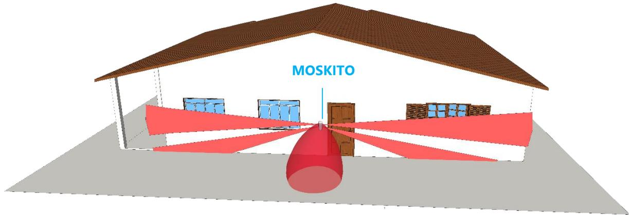
Moskito puede proteger la fachada de un edificio en ambos lados (izquierdo y derecho). Se recomienda instalar el detector en el centro de la fachada.
