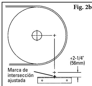
4. **Localice la posición del soporte de montaje (posición horizontal).** Para ubicar la posición del soporte de montaje del limpiador, agregue 56 mm (2-1/4") a la marca de intersección (Figura 2b). Esta marca indica el centro superior del soporte de montaje.
