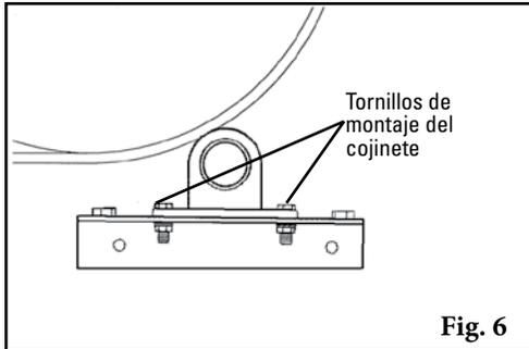
6. **Instale el eje.** Retire los dos tornillos de montaje del buje de uno de los montajes del buje (Fig. 6). (Si es el montaje del chute, retírelo de la parte lateral con el orificio de acceso). Deslice el eje a través de la polea y hacia el montaje del buje del otro lado y permita que las hojas caigan. Instale el montaje de buje que se retiró en el eje y vuelva a sujetar el soporte de montaje. **NOTA:** No apriete; apriete con la mano.
