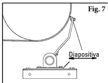
9. **Coloque el eje.** Gire el eje hacia arriba para que las hojas estén en contacto con la polea motriz (Fig. 7). Centre las hojas en la banda. Mientras aplica una leve presión en la hoja central, mueva el montaje flojo del buje hasta que las hojas hagan contacto uniforme con todo el ancho de la banda. Fije el limpiador en esta posición al apretar los tornillos de montaje del buje.
