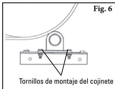
8. **Instale el eje.** Retire los dos tornillos de montaje del buje de uno de los montajes del buje (Fig. 6). (Si es el montaje del chute, retírelo de la parte lateral con el orificio de acceso). Deslice el eje a través de la polea y hacia el montaje del buje del otro lado y permita que las hojas caigan. Instale el montaje de buje que se retiró en el eje y vuelva a sujetar el soporte de montaje. No apriete; apriete con la mano.
