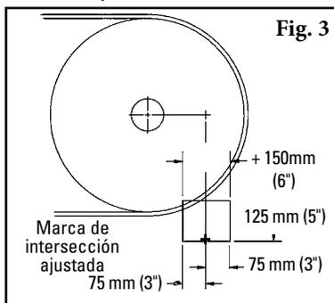
5. **Corte la abertura del chute.** Utilizando la marca de intersección ajustada ("+") que estableció en el Paso 4, trace y corte la abertura requerida de 125 x 150 mm (5" x 6") en el chute (Fig. 3). Si se requiere un orificio de acceso, consulte el Paso 7.
