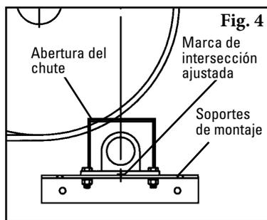
6. **Instale las placas de montaje.** Centre el soporte de montaje en la parte inferior de la abertura. Atornille o suelde en su posición (Fig. 4). Repita el proceso en el lado opuesto.
