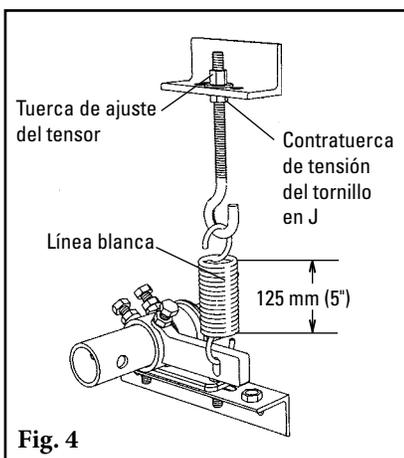
**9. Fije la tensión del resorte.** Afloje la contratuerca de tensión del tornillo en J y gire la tuerca de ajuste del tensor hasta que la bobina sea de 125 mm (5") de largo. Mida la longitud de la línea blanca del resorte (Fig. 4).
