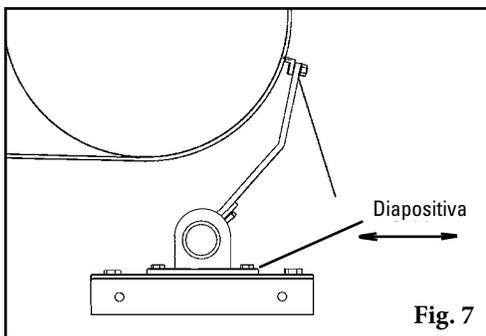
7. **Coloque el eje.** Gire el eje hacia arriba para que las hojas estén en contacto con la polea motriz (Fig. 7). Centre las hojas en la banda. Mientras aplica una leve presión en la hoja central, mueva el montaje flojo del buje hasta que las hojas hagan contacto uniforme con todo el ancho de la banda. Fije el limpiador en esta posición al apretar los tornillos de montaje del buje.
