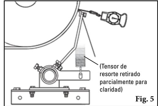
11. **Mida la longitud del resorte y fije la etiqueta.** Después de haber confirmado la tensión de resorte correcta, mida la línea blanca en el resorte. Con un bolígrafo marque la longitud del resorte en la etiqueta Longitud de resorte proporcionada en el paquete. Fije la etiqueta en la estructura del transportador cerca del resorte para tener una referencia futura para la tensión o retención de las hojas.
