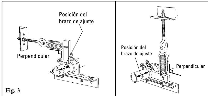
**8c. Instale un brazo de ajuste en el extremo del eje.** Gire el tensor alrededor del eje hasta que se ubique la posición de montaje óptima. El montaje del tornillo en J se puede ubicar en cualquier posición 360° alrededor del eje. El único requisito es que el tornillo en J y el resorte permanezcan perpendicular al brazo de ajuste (Fig. 3).
