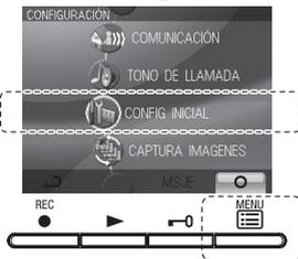
3 Presione el botón **▲** o el botón **▼** para seleccionar el elemento que desea configurar o verificar, y fije la configuración con el botón **MENÚ**.
