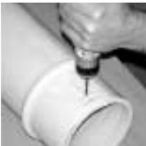
11. Marque y haga los orificios que servirán para atornillar los soportes "L" de 1 pulgada. (Soportes "L" se venden por separado).
