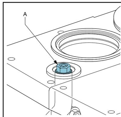
1. Conecte el tubo de llenado al grifo de carga/vaciado y llene la instalación con agua potable limpia, hasta una presión máxima de 1-2 bar con la instalación en frío.
