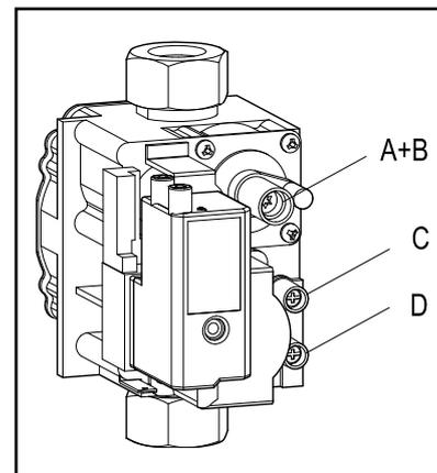
*Atención: Compruebe la estanquidad de las boquillas de medición utilizadas*
