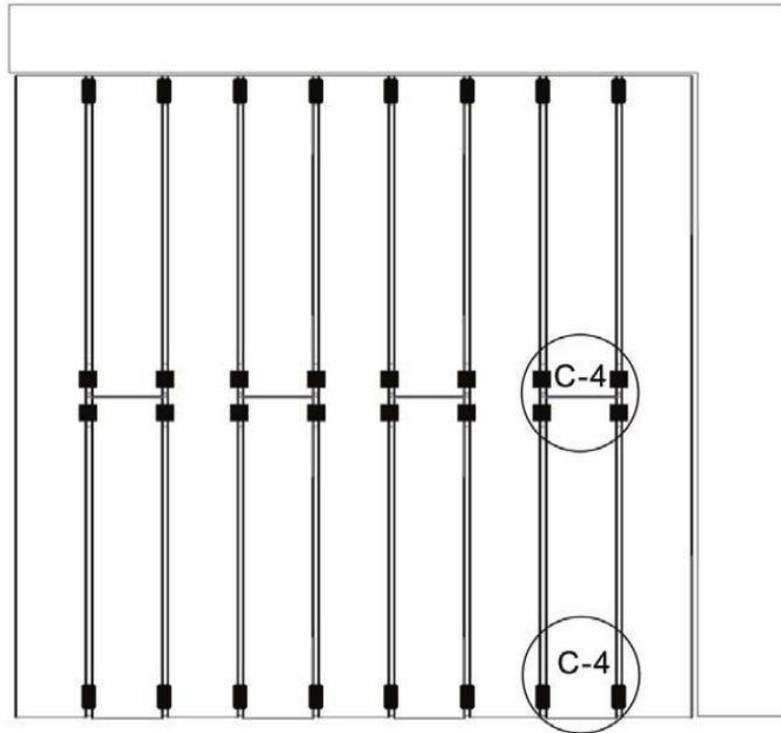
4. Inserte uno de los brazos del perfil tipo C – 4 en el lado acanalado del listón de madera y atorníllelo en la viga longitudinal. Repita el proceso con el listón siguiente.
