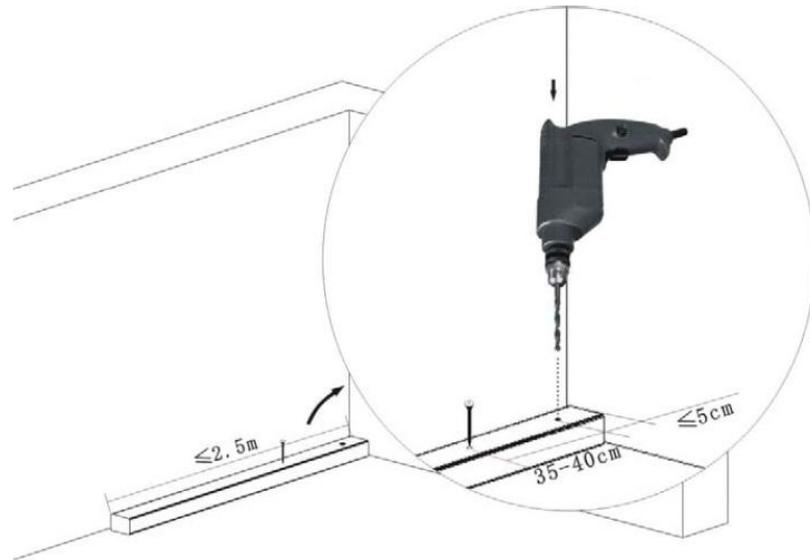
1. Ubique la primera viga en el mismo sentido del declive del piso, dejando una dilatación de 20 mm. con respecto a las paredes.
