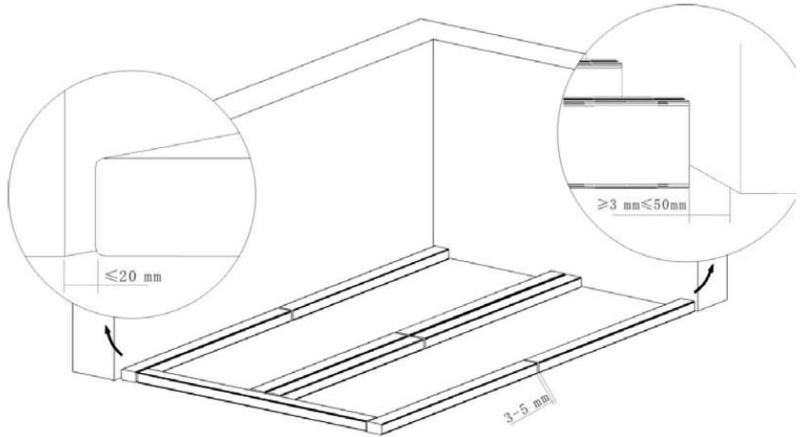
4. Remate el espacio entre las vigas longitudinales con vigas transversales, dejando un espacio de cinco milímetros entre unas y otras.
