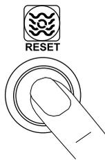
**NOTA:** Si no lo consigue después de 15 minutos, significa que el horno ha activado el modo de bloqueo de seguridad que anula el interruptor "RESET" (Reiniciar) . Si ocurriera esto, apague los interruptores "HEAT" (Calor) , "BLOWER" (Ventilador) y "CONVEYOR" (Cinta transportadora) (posición "O"). **Espere AL MENOS CINCO MINUTOS.** Luego repita el procedimiento diario de encendido.
