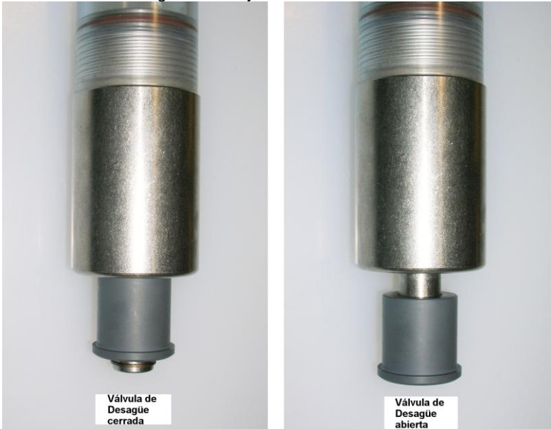
Figura 2-1 Funcionamiento de la Válvula de Desagüe
