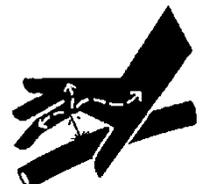
**Las mangueras hidráulicas pueden fallar debido a envejecimiento, daños y exposición. No busque fallas hidráulicas sin protegerse el cuerpo y la cara. Una fuga minúscula, casi invisible puede penetrar en la piel, haciendo que se requiera una atención médica inmediata. Use un pedazo de madera o cartulina para detectar las fugas hidráulicas; no use nunca las manos.**
