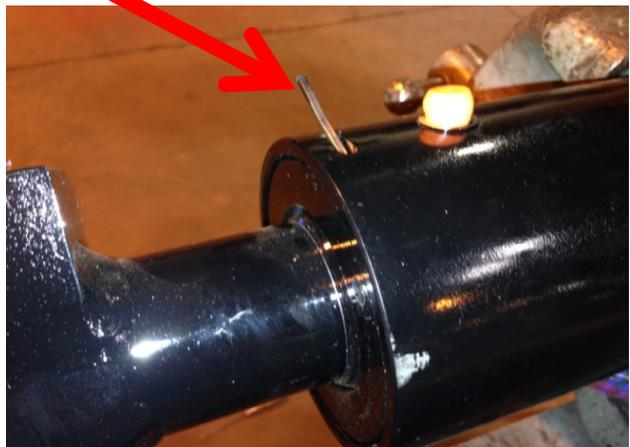
3. Asegúrese de que el orificio de la manguera esté abierto para permitir la entrada de aire en el cilindro. Tire de la varilla del pistón hacia afuera para quitar el cojinete superior.
