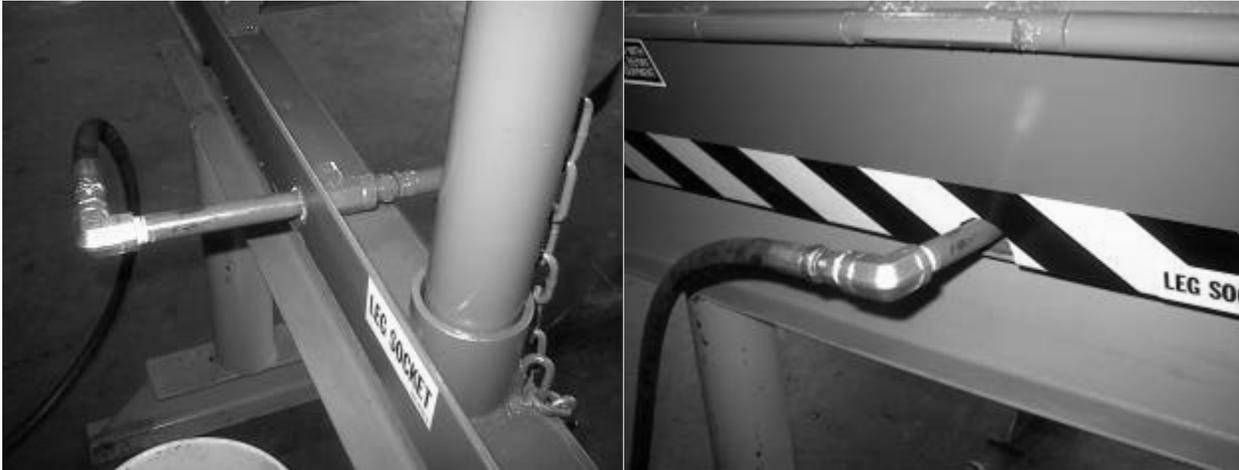
7. Compruebe el tendido de las tuberías hidráulicas temporales para asegurarse de que la manguera esté alejada de las patas, el bastidor de base y la plataforma cuando el elevador esté en la posición bajada.
