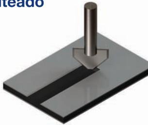
Se debe routear un radio mínimo de 2 mm
