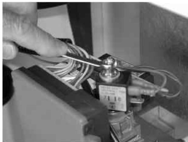
La presión de salida se debe medir en la toma de presión situada en la barra de soporte del inyector de gas para evitar una pérdida de carga debida al codo después de la válvula.
