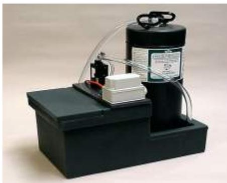
Sistema que dosifica con precisión bajas cantidades de químico de desecho fotográfico del proceso de revelado a un filtro de reemplazo metálico (intercambio iónico) para recuperar la plata disuelta y cumplir con la norma ambiental vigente.
