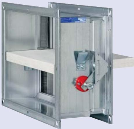
En caso de incendio, las compuertas cortafuego se cierran de manera automática evitando la propagación de fuego y humo hacia otros sectores de incendio, a través de la red de conductos de aire. Las compuertas cortafuego FKA-EU están ensayadas en cumplimiento con EN 1366-2 y cumplen con las exigencias de EN 15650. Además, también debe tenerse en cuenta la normativa nacional vigente.
