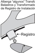
Alberga "algunos" Transformadores Electrónicos Balastos y Transformadores grandes requieren de Registro de Instalación Remota.
