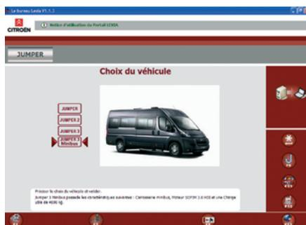
El adaptador PR 9780.X4 es necesario para los Jumper 3 pero, en función de la versión elegida, la herramienta pide que se sitúe en el modo "A" o "B" ("B" para los Jumper 3 versión "minibus" y "A" para los demás Jumper 3).
