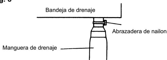
Coloque el aislante (manguera de drenaje) alrededor de la conexión de la manguera de drenaje (Fig. 9).
