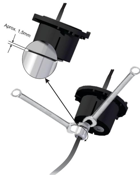
Al terminar el ajuste, la tuerca NO debe quedar deformada.
