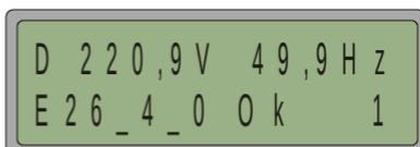
Cuando los valores de voltaje, frecuencia e impedancia de la red están dentro de los rangos permitidos por mas de 20 a 30 segundos, los relevos son activados y la energía del generador es transferida a la red eléctrica. La red eléctrica es monitoreada a partir de este momento.
