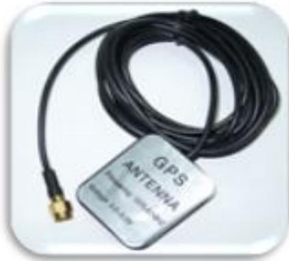
Atornille la antena GPS en el conector del BlackBox que dice GPS. Luego, despliegue la antena GPS y colóquela en un lugar oculto pero que no esté interrumpida por un campo electromagnético ni por una lamina de metal ya que puede interrumpir con la señal GPS y podría tener problemas de cobertura.
