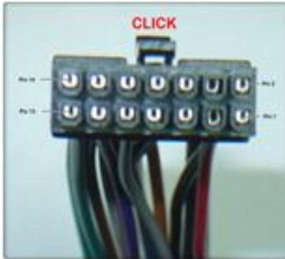
Coloque el conector hembra con cables en el conector macho que está en el equipo con el clic hacia arriba de manera que calce perfectamente en la muesca de la caja del equipo.
