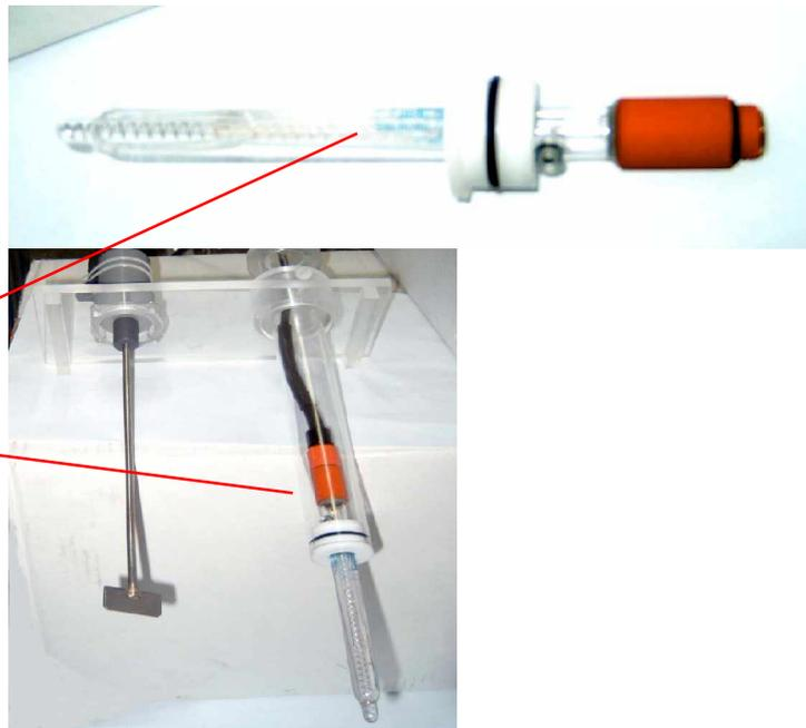
Ajuste el tornillo de anclaje, colocado en la parte superior de sensor de pH, para que éste alcance la posición ilustrada en la figura.
