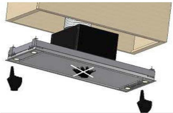
Una vez introducido el cuerpo de la campana en el hueco, ya no hay necesidad de sujetarlo ya que se mantiene solo gracias a los soportes de montaje "Click & Fix"
