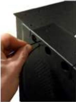
Una vez que el dispositivo este instalado y conectado al sistema de alarma, insertar los tornillos laterales (para simular el cierre del tamper) sin las puertas de metal laterales y los cilindros, para mantener el acceso a la tarjeta electrónica interior y presionar uno de los dos botones (derecho o izquierdo) para programar el tiempo de disparo.
