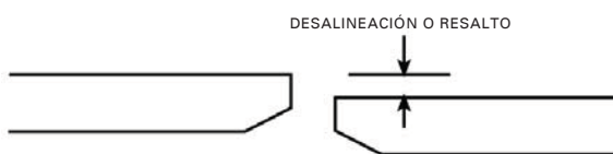
Figura 4-9: Desalineación o resalto
