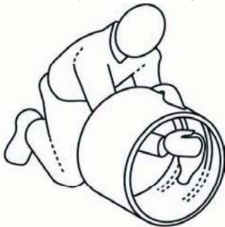
Figura 4-1: Limpieza del acople
