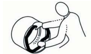
Figura 4-2: Instalación de los empaques de sello
