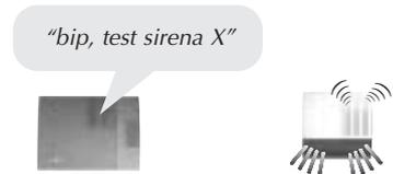
Si la sirena presenta un defecto de alimentación (pila gastada), la señalización de la sirena es seguida de un acquit particular indicando este defecto.
