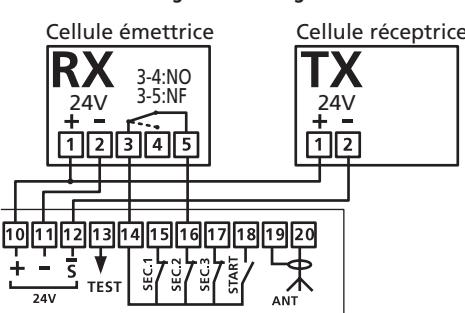
Câblage de points de commande séquentiels
