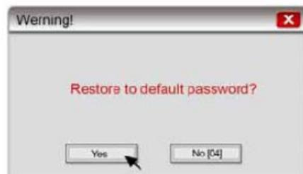
En caso de que el usuario pierda u olvide las contraseñas del sistema, debe colocar el conmutador DIP 1 en la posición ON, manteniendo el resto en posición OFF y a continuación, reiniciar el V-Touch 7.0.
