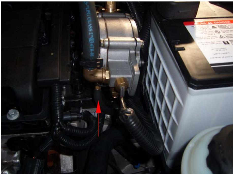
Dirigir al otra parte del tubo hacia la toma del sensor de presión.
