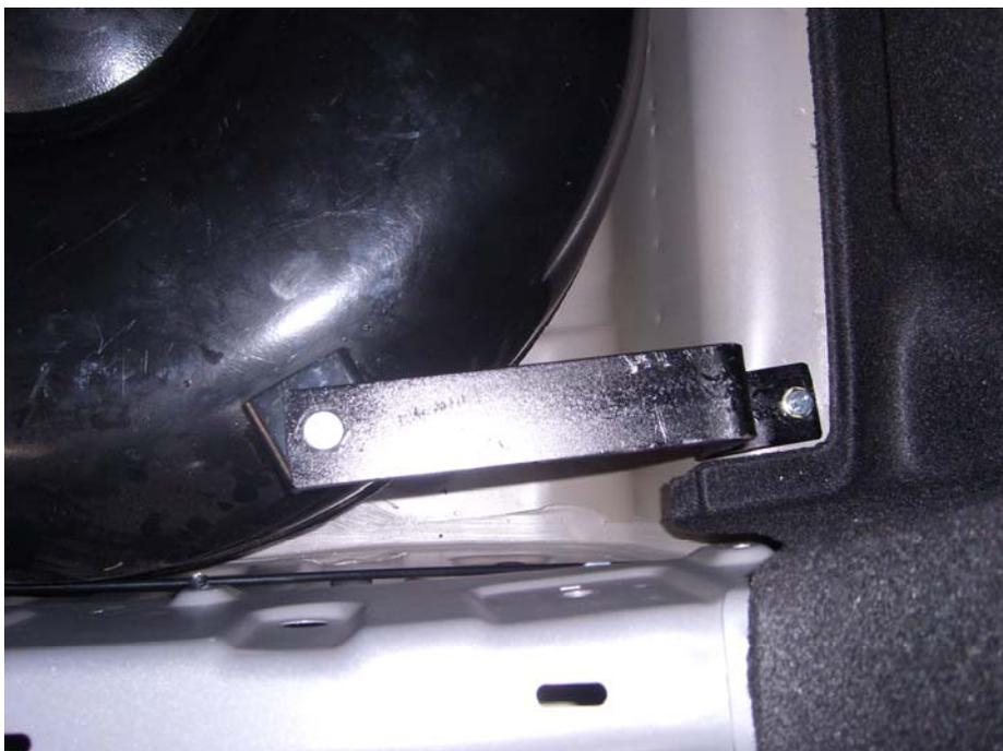
Éste último (posterior derecho) se fija a la chapa con un tornillo M8, tuerca y arandela.
