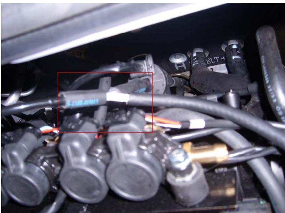
Conectar tubo de vacío y realizar otra bifurcación en forma de “T” para que parte del tubo se fije a la toma del evaporador.
