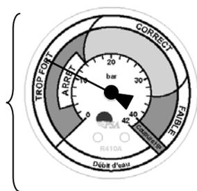
Posición normal de la aguja del manómetro durante el funcionamiento de la máquina (compresor y ventilador(es) ON). Esta posición puede variar en la zona "CORRECTO" según las temperaturas del agua y aire ambiente, hasta alcanzar la zona "DÉBIL" cuando un caudal de agua demasiado débil llega a pasar por el aparato.
