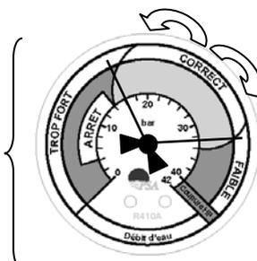
**Recuerde** : Si al ajustar el by-pass y las válvulas de ajuste, el caudal de agua es inferior a 1,5 m<sup>3</sup>/h la bomba de calor no funcionará (el controlador de caudal con álabes se pone en marcha y el regulador indica AId alternativamente con la temperatura del agua del estanque.) Entonces es necesario ajustar las válvulas : - V5 (si presente) o -V3- y -V1-.
