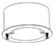
3. Aprieta parcialmente los tornillos de montaje de cabeza plana de la caja eléctrica. Se proporcionan dos de los siguientes sujetadores 8-32, selecciona los sujetadores según sea necesario para la caja eléctrica.
