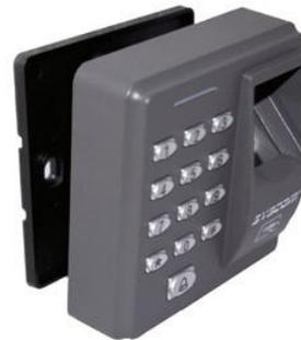
1.4 Coloque el lector en la cubierta trasera.
