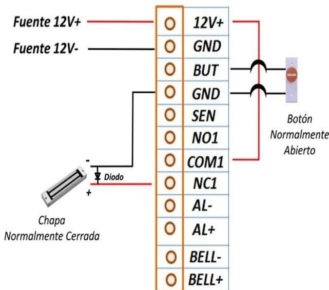
Conexión de chapa con circuito normalmente abierto: Compartiendo la misma fuente:
