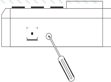
1.1. Con el desarmador o llave de punta torx incluida, remueva el tornillo de seguridad de la parte inferior.
