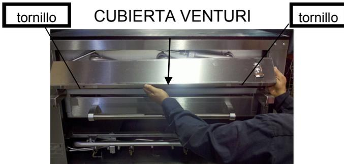
FIGURA 1. CUBIERTA VENTURI
