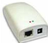
**Convertidor de RS232 a ETHERNET.**
