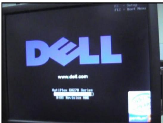
Puede suceder que este paso no le funcione, por lo que se tiene otra alternativa para seleccionar la opción de booteo, es un poco más difícil pero siguiendo los pasos no tendrá ningún problema para lograrlo. Primero debe reiniciar la computadora y en la pantalla que muestra DELL debe presionar F2 para acceder a la configuración (setup) de la computadora.
