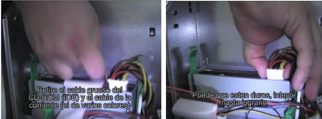
Este mismo procedimiento se repite para la unidad lectora de discos de 3" ½ (floppy) y para el disco duro, se retira el cable grueso y la corriente y después se extraen jalando los plásticos de color verde.
