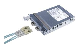
Conecte el otro extremo del cable a un conmutador o dispositivo de almacenamiento que se admita.
