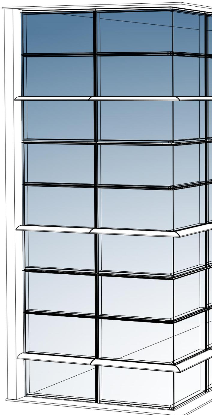
El sistema ES-U3725, es un sistema unitizado para fachadas. Los sistemas unitizados permiten ahorrar tiempo en los procesos de instalación, el anclaje, limpieza, sellado y la posibilidad de acomodarlo a las variaciones de las losas en obra.
