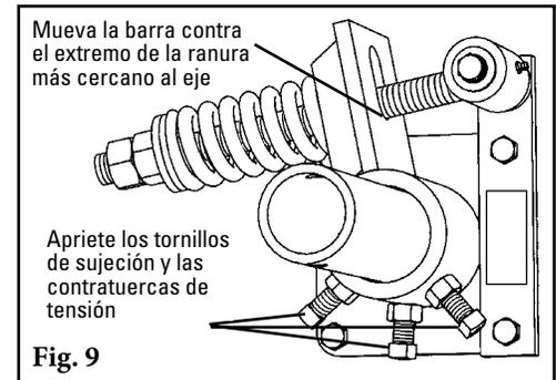
16. **Establezca la tensión correcta de la hoja.** Consulte la tabla en el soporte eje pivote (también se muestra posteriormente) para obtener la longitud requerida del resorte para el ancho de la banda. Jale levemente el brazo del pivote hacia el extremo de la ranura del brazo de torsión cercano al eje y gire las tuercas de ajuste hasta que se logre la longitud del resorte requerida (Fig. 10). Bloquee la tuercas de ajuste superior.
