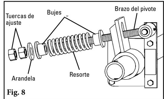
15. **Aplique tensión a las hojas en la banda.** Gire las hojas hasta que hagan contacto con la banda. Mientras sostiene el buje del resorte fijo sobre el brazo de torsión, gire el brazo de torsión hasta que el brazo del pivote quede contra el extremo de la ranura más cercana al eje. Apriete los tornillos sujetadores y las contratuercas de tensión en el brazo de torsión (Fig. 9). **NOTA:** El brazo de torsión debe estar contra la placa de montaje.
