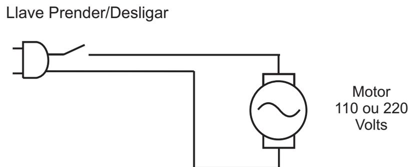
Antes de encender el equipo verifique si el voltaje de la máquina es el mismo que lo de la red eléctrica, 110 o 220V. Si necesario ajústelo utilizando la Llave Selectora de Voltaje N° 07 (Fig.01) ubicada en la parte inferior de la máquina.
