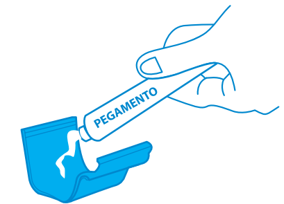
Fig. 13. Aplicación de pegamento a las uniones.
