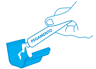
Fig. 13. Aplicación de pegamento a las uniones.
