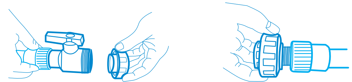
Fig. 29. Conexión de tuerca de Válvula General a conector macho de ensamble de Bomba.
