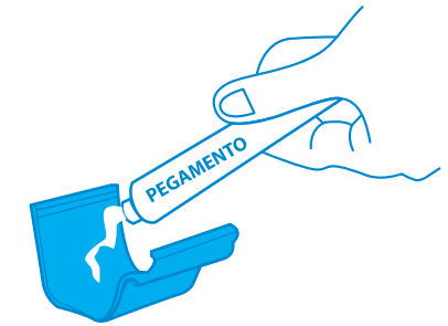
Fig. 13. Aplicación de pegamento a las uniones.
