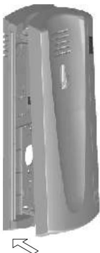
Pasar los cables por el orificio dispuesto a tal efecto, y conectarlos a la regleta según los esquemas de instalación. Cerrar el teléfono tal y como muestra el dibujo. Una vez cerrado, conectar el auricular mediante el cordón telefónico y colocarlo en la posición de colgado.
