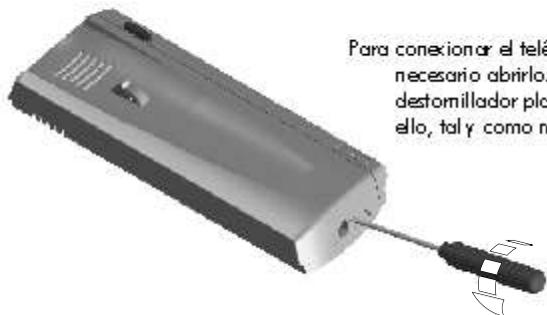
Para conectar el teléfono y fijarlo a la pared, es necesario abrirlo. Realizar levemente palanca con un destornillador plano en las ranuras dispuestas para ello, tal y como muestra el dibujo.
