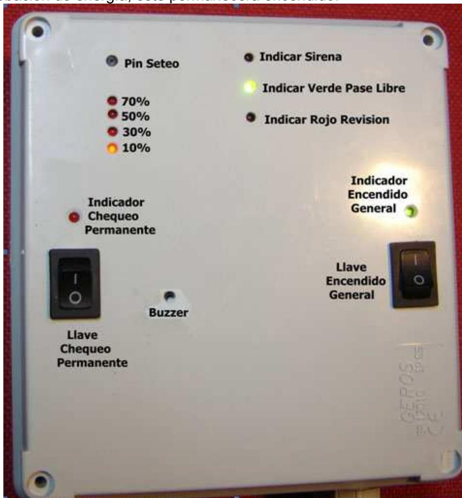
El dispositivo realizara la secuencia de test, se encenderán progresivamente los led de porcentaje y apagarán.
