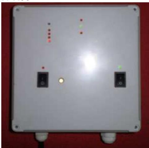
El dispositivo está provisto de un interruptor Negro de encendido general y su indicador de encendido (verde)
