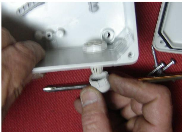
Introduzca el cable control (no proporcionado), este debe de ser de **6 conductores mínimo y de 1mm de sección:**
