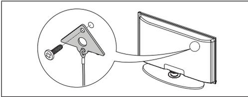
2. Apriete firmemente el tornillo en la pared o el mueble donde se instala el televisor. Asegure el soporte al televisor y al tornillo de la pared o el mueble.
