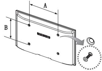
Destornille los tornillos del kit antes de instalar el montaje mural en la pared.
