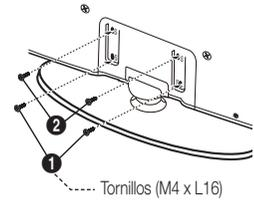
3. Atornille los dos tornillos (M4 x L16) en la posición ❶ y los otros dos (M4 x L16) en la posición ❷.
