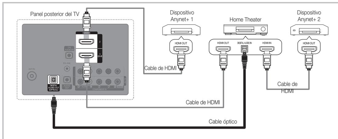
1. Conecte los terminales HDMI IN (1 (DVI) o 2) del televisor y el terminal HDMI OUT del dispositivo Anynet+ correspondiente mediante un cable HDMI.
