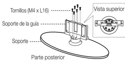
1. Conecte el soporte de la guía con el soporte mediante seis tornillos (M4 x L16), tal como se muestra.
