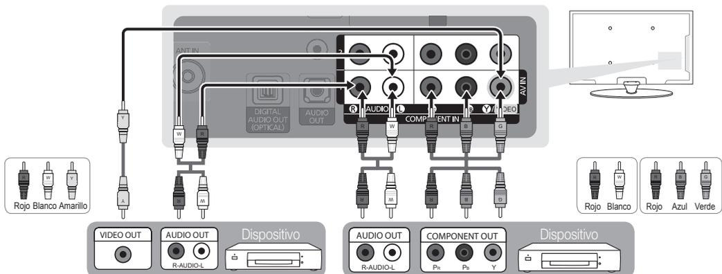
AV IN: Cuando se conecta a, AV IN en el color (verde) del terminal AV IN [Y/VIDEO] no coincide con el cable de vídeo (amarillo).
